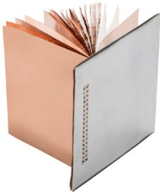
BILD 3 Mit Ultraschall geschweißte hauchdünne Kupferfolien auf einem vernickelten Kupfer-Tab aus dem Inneren einer Batterie (© Schunk Sonosystems)
